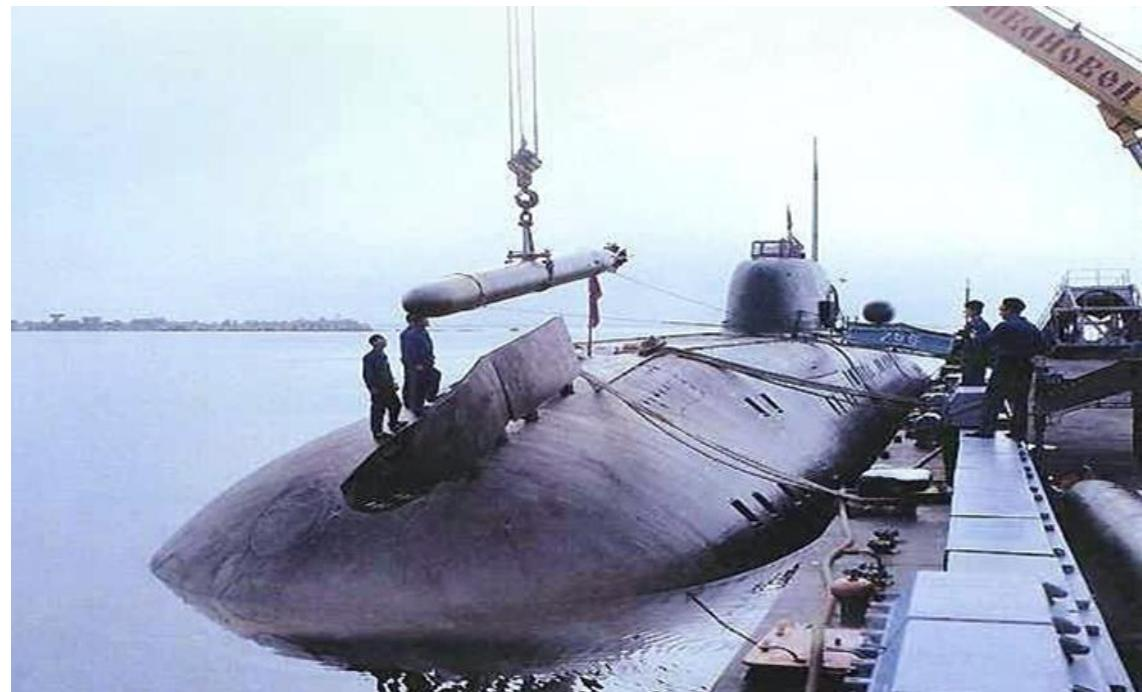
**Атомная многоцелевая подводная лодка проекта 671РТМ. Погрузка торпед перед боевым походом.**
