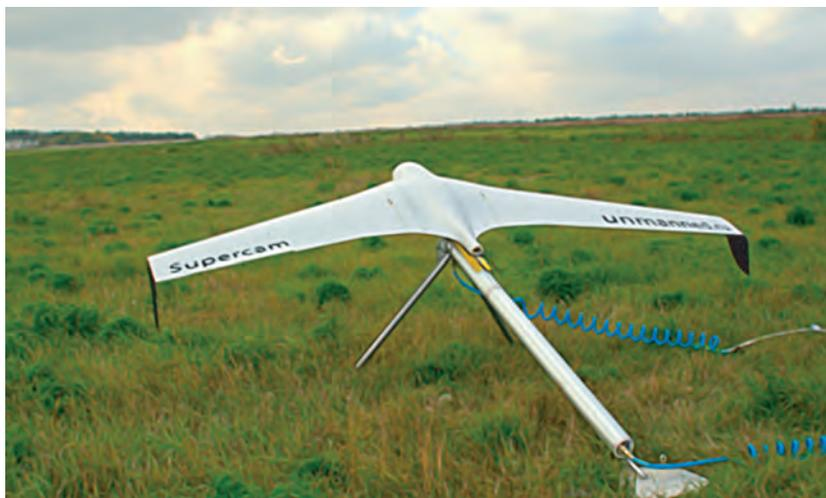
Рис. 2. БПЛА Supercam S-300M («Буревестник»)
