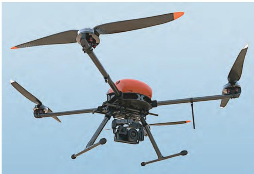
Рис. 3. БПЛА Геоскан 401 Про
