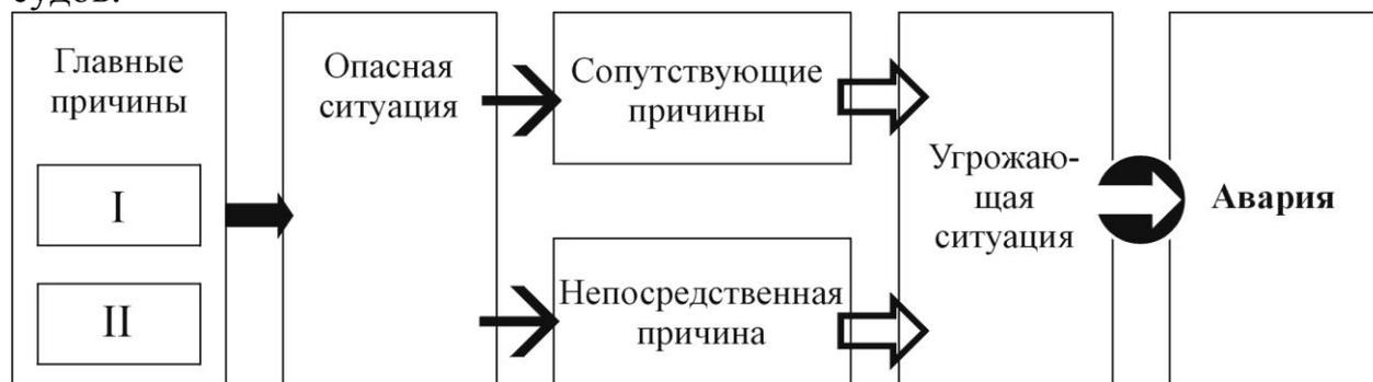
Рис. 1.2.1. Блок-схема причинных связей навигационных аварий
